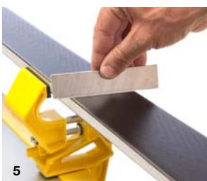
Abb. 5) Kontrolle mit dem Prisma Straight Edge.
