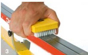
Der Ski wird erst ganz am Schluss, d.h. nach dem Waxen, Abziehen und Ausbürsten, strukturiert.
