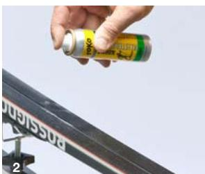
Abb. 2) Eine Schicht Nordic KlisterSpray Base green auf die Abstosszone sprühen. (Je eine Skihälfte besprühen).
