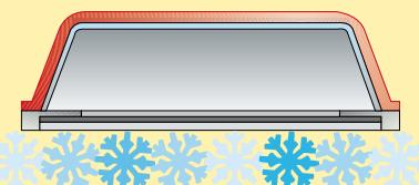
Bei kaltem, kristallinem Schnee sollte die Lauffläche so glatt wie möglich sein, um die Reibungspunkte so gering wie möglich zu halten.
