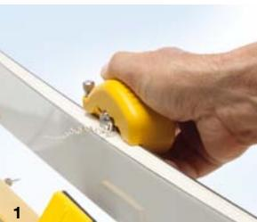
Abb. 3) Feilen mit dem Edge Tuner Pro. Mit dem Edge Tuner Pro lässt sich die Kante einfach feilen. Durch die Verwendung von kugelgelagerten Führungsrollen arbeitet der Edge Tuner Pro belagschonend und genau. Es lassen sich alle TOKO-Feilen und -Diamantwerkzeuge einspannen.
