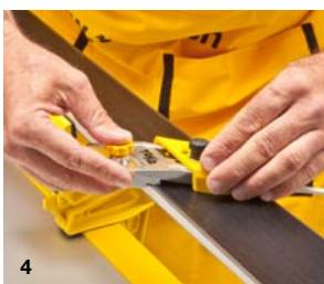
Abb. 4) Kante mit dem Multi Base Angle abhängen. Sollte der Ski zu wenig hängend gefeilt sein (Ski dreht schlecht), wird er belagsseitig mit dem Multi Base Angle bearbeitet (Winkel einstellbar zwischen 0,5° – 2,0°).
