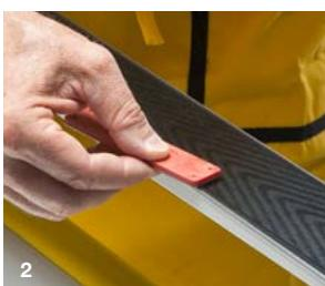
Abb. 2) Mit der Diamond File red feine Brauen und feine Grate entfernen. Kann auch mit dem Base Angle World Cup oder Multi Base Angle verwendet werden, somit ist die Diamond File geführt und kann nicht verkanten. Leichten Rost mit dem Schleifgummi entfernen. Grobe Macken und Verhärtungen mit dem Universalschleifstein oder der Diamond File blue entfernen.
