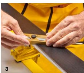
Abb. 3) Kante mit dem Base Angle World Cup abhängen. Sollte der Ski zu wenig hängend gefeilt sein (Ski dreht schlecht), wird er belagsseitig mit dem Base Angle World Cup bearbeitet (nach Bedarf auf 0,5° oder 0,75° oder 1,0°).
