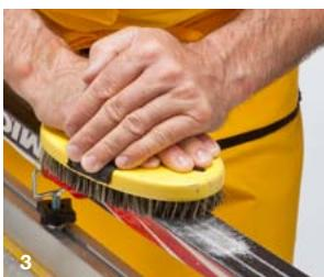
Abb. 3) Mit Kupferbürste ausbürsten. Nach dem Auswaxen muss der Belag mit der Kupferbürste in Laufrichtung gründlich ausgebürstet werden.
